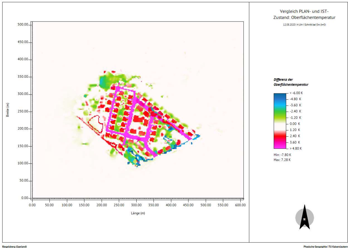
Abbildung 32: Vergleich der Oberflächentemperatur von Plan- und Ist-Zustand am 12.08.2020 um 4.00 Uhr, innerhalb des Untersuchungsgebietes „Wohngebiet Auf dem Hahn“.
