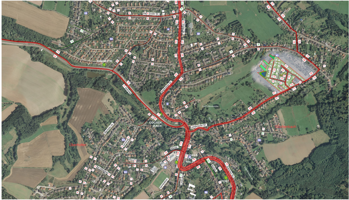
Abb. 10: VISSIM-Verkehrsmodell, Differenznetz, Ausschnitt
