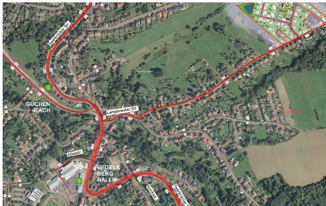
Abb. 11: VISSIM-Verkehrsmodell, Differenznetz, Detail B268 Saarbrücker Straße / Lampenester Straße
